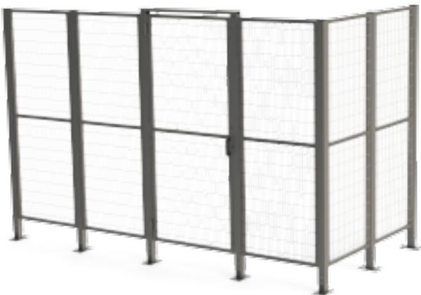
Das System, das die Anforderungen der Lebensmittelindustrie erfüllt, basiert auf dem gleichen stabilen und soliden Design wie ProSafe und ist in unterschiedlichen rostfreien Qualitäten erhältlich. Die Elemente bestehen aus stabilen 30x30 mm Edelstahlrohren. Die Pfosten aus 60x60 mm starken Rohren haben entweder einstellbare oder verschweißte Füße. Das Wellengitter aus 3 mm starkem Draht in säurefester Qualität hat eine Maschengröße von 30x30 mm.
