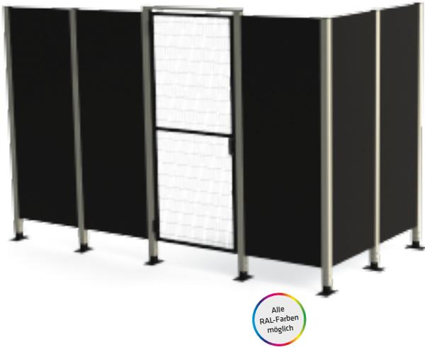
SolidSafe™ basiert auf dem gleichen stabilen und soliden Design wie ProSafe. Die Elemente bestehen aus 30x30 mm starken Vierkantrohren, die mit 0,9 mm starkem Stahlblech verkleidet sind. Diese bieten einen gewissen Lärmschutz und können ohne Gefährdung der Sicherheit sehr dicht am Gefahrenbereich montiert werden, wobei sie auch als Sichtschutz für zu schützende Prozesse dienen können.
